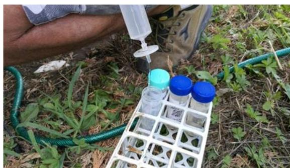
Foto 15: Fasi di campionamento delle acque di falda
