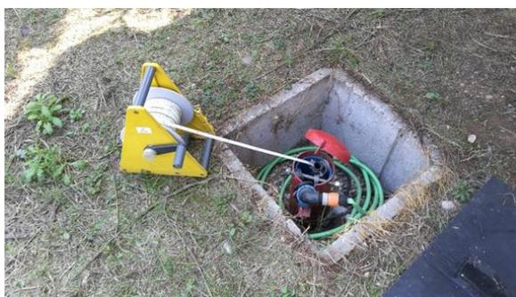
Foto 14: Misura livello di falda nei piezometri di monitoraggio
