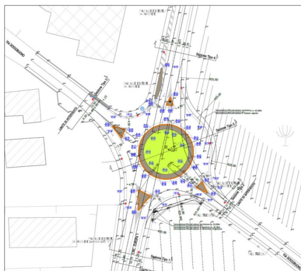
Figura 4 - Progetto per la realizzazione di una nuova rotondina all'intersezione di via Circonvallazione Europa (S.P. n. 26) e via Dossobuono
